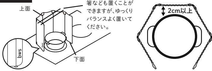
使用する際は上下を確認し、上図のようにロゴマークが左外側になるように設置してください。
