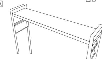
4 下図のように、3で組み立てた①の最下段とお好みの高さのワイヤー部分に、④を③と同様に引っ掛けてください。次に、①の2本のワイヤー部分に⑧を3個引っ掛けください。(左右どちらにも引っ掛けられます。)
