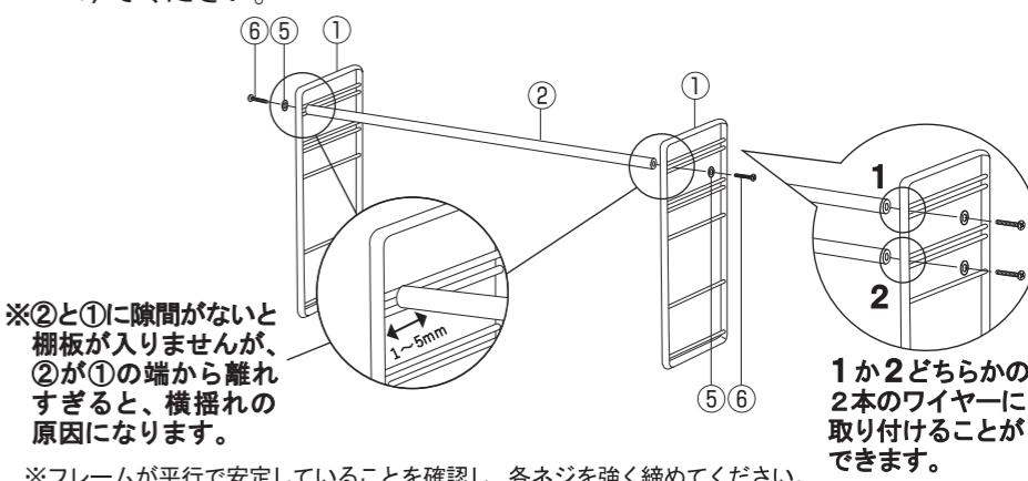
※フレームが平行で安定していることを確認し、各ネジを強く締めてください。
