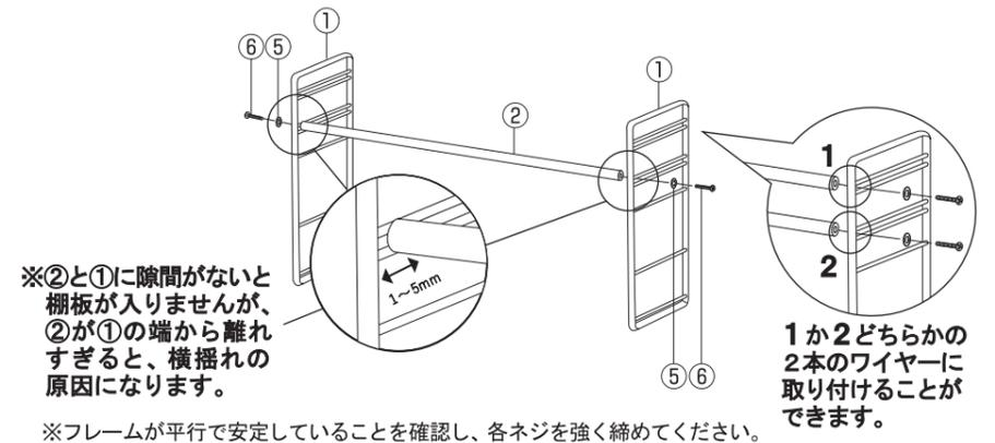
**3** 下図のように、2でパイプを取り付けた①に、③の片側を通してから反対側を引っ掛けてください。
