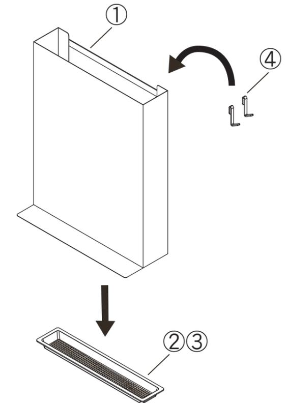
※③に水が溜まった際は、①を持ち上げて移動し、その後、③の水を捨てるようにしてください。①の上部から手を突っ込んで③を抜き取ろうとすると、①の端面に引っかかりけが等をする恐れがあります。
