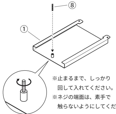
**2** 下図のように、①で取り付けた⑧に④を回して取り付けてください。
