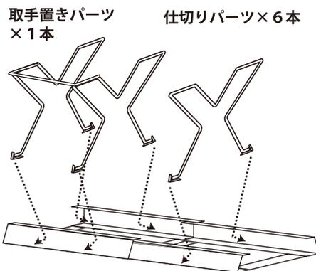
スライドパーツの内側の側面に仕切りパーツ（取手置きパーツ）のくの字の引っ掛け部を当ててください。
