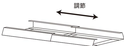
2. 仕切りパーツや取手置きパーツの両側を手ではさみ、引っ掛け部を内側から、スライドパーツに取り付けてください。次に使用する鍋やフライパンの厚みに間隔を合わせてセットしてください。
