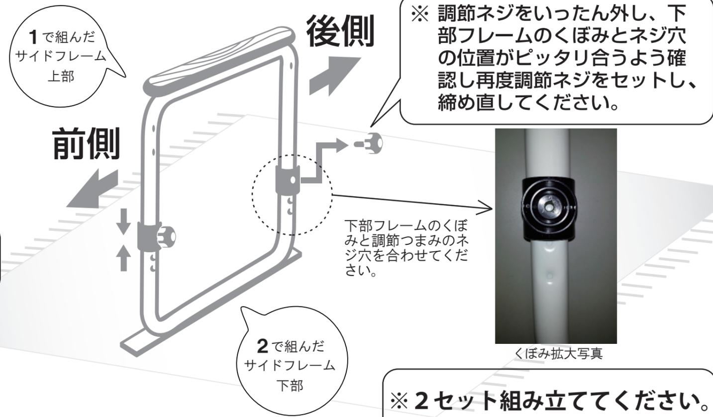
**4** 3で組み立てたサイドフレームに③を①で取り付けてください。
