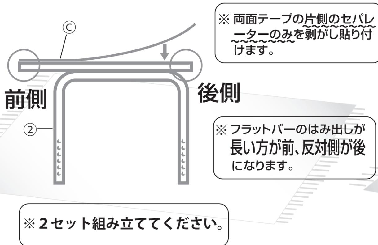
**3** 1で組み立てたサイドフレーム上部と2で組み立てたサイドフレーム下部を、前後の向きに気をつけて差し込んでください。差し込む際、お好みの高さに調節してください。
