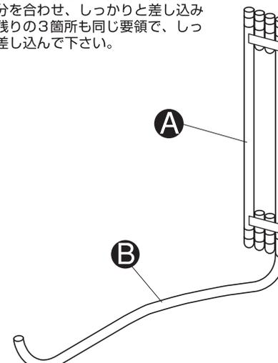
2 次に、ターミナルパイプAの上部の凸部分にCの凹部分を合わせ、しっかりと差し込みます。他の3箇所も同じ要領で、しっかりと差し込んで下さい。
