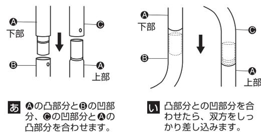
1 ターミナルパイプAの下部の凸部分にCの凹部分を合わせ、しっかりと差し込みます。残りの3箇所も同じ要領で、しっかりと差し込んで下さい。
